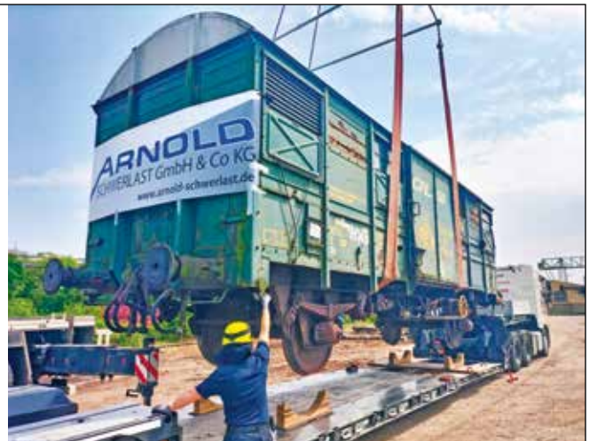
Mit Hilfe eines schweren Autokrans wurden die beiden Eisenbahnwaggons auf den bereitstehenden Tieflader gehoben. Die Fahrt ging vom Verladebahnhof Würzburg-Zell zur Staatlichen Feuerwehrschiele in den Würzburger Stadtteil Zellerau. Foto: ARNOLD
